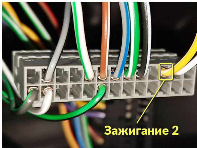
Зажигание 2 – желто-белый провод, контакт № 24 «+»;
