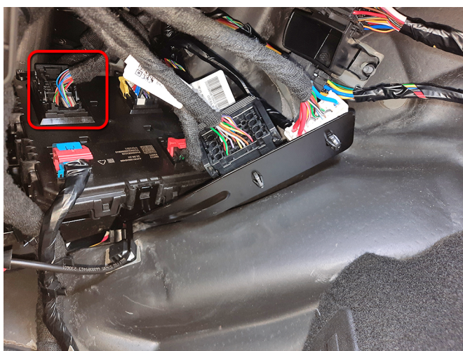
Подключение производится в черном 52-контактном разъёме блока VCM слева от рулевой колонки
